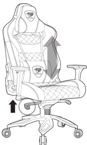
Регулировка высоты (рычаг справа)
